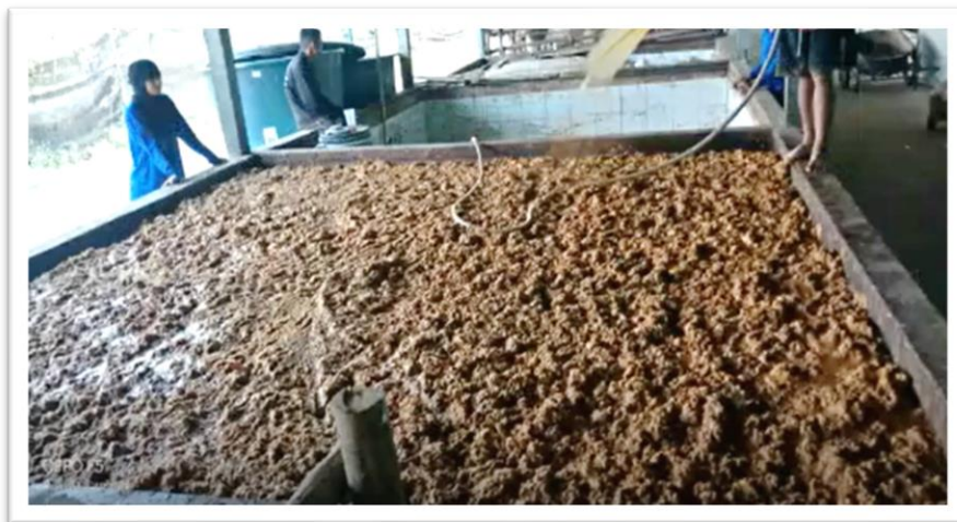
ภาพการผลิตกากมันหมักยีสต์ จะทำในบ่อหมักจำนวน 3 บ่อ บ่อละ 10 ตัน ขนาด 4*4*0.8 เมตร
